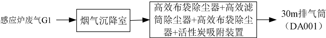
图 3-1 项目废气处理工艺流程图
